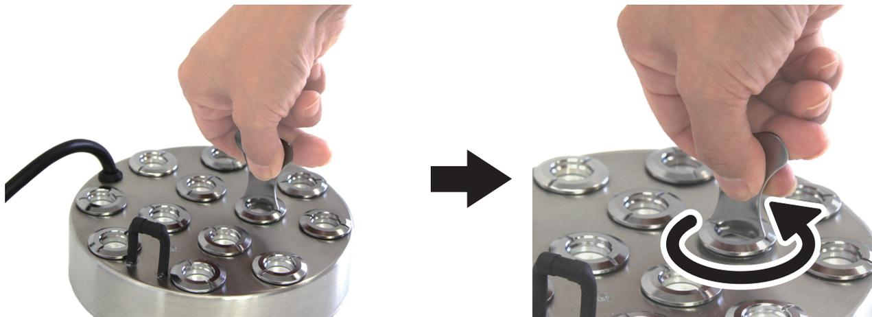
工具をリング溝に差し込み、**左回し** でリングを緩めます
