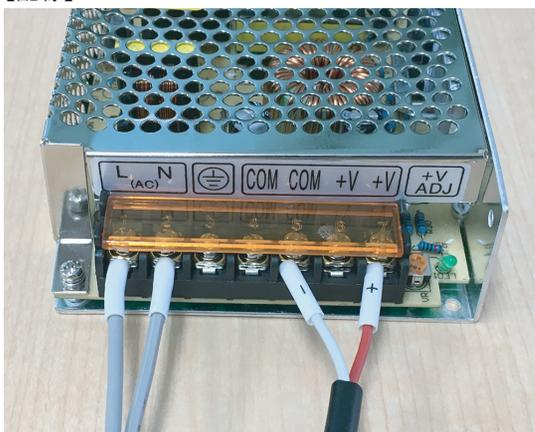
※プラス(+)とマイナス(-)に十分注意して接続してください。間違えますと破損の原因になります。
