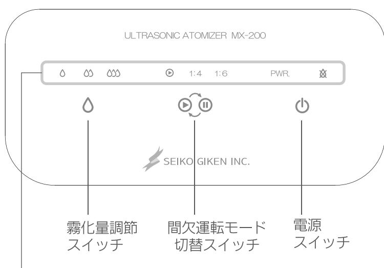
■ランプ (選択されたモードのランプが点灯します)
