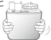
液体タンクに衝撃を加えると、破損して液体漏れの原因になります。液体タンクのお取り扱いには十分に注意してください。
