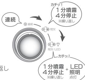
▶▶▶間欠/LED **間欠運転+LED照明点灯モード**
