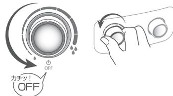
※電源をOFFにして、再度電源をONにする場合は、5秒程度あけてから電源を投入してください。
